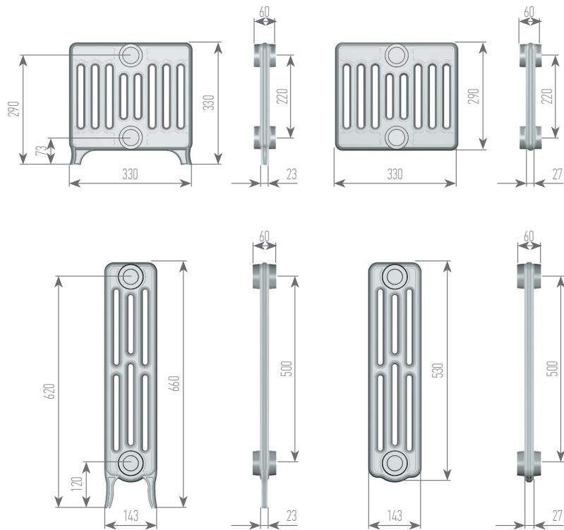
Размеры радиатора указаны без учета установленной арматуры и воздухоотводного клапана
